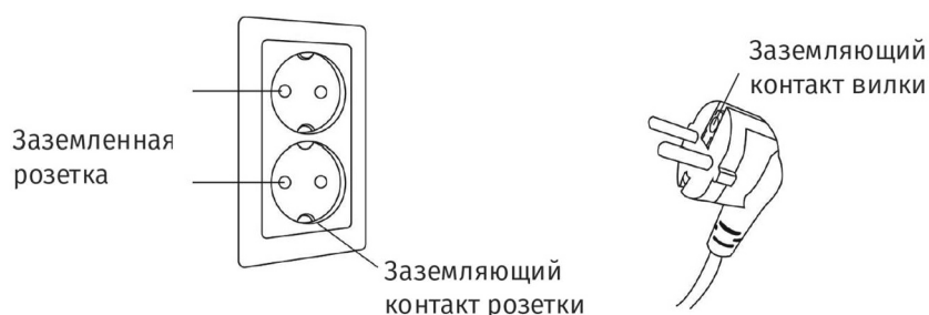
Рисунок 10 - Правильное заземление массажного кресла
